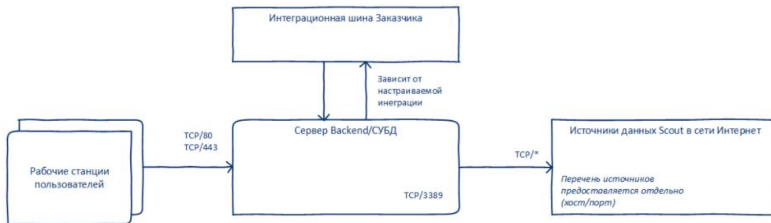
Рисунок 2 – Схема взаимодействия серверов
